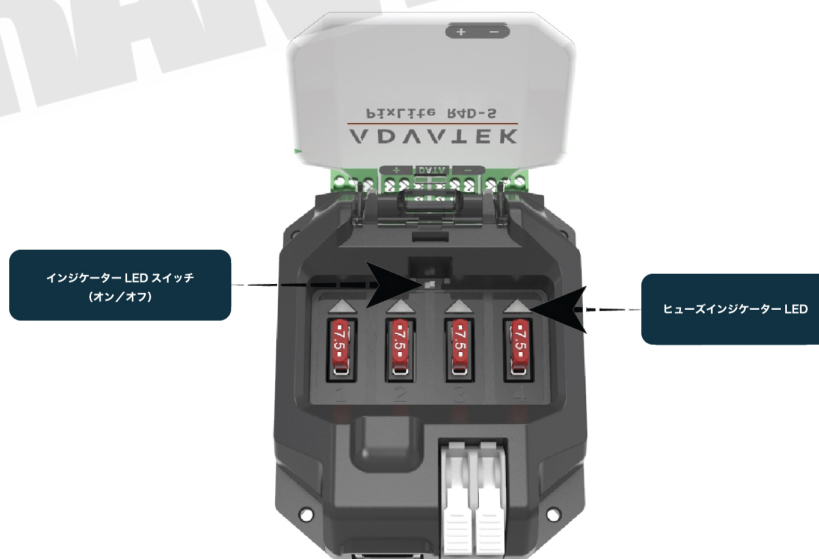
図 14：インジケータLEDとスイッチの位置
