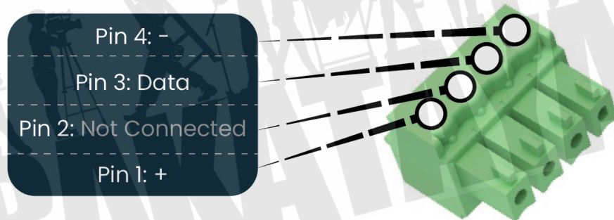
図 12：拡張モードのピクセル出力ピン配置
