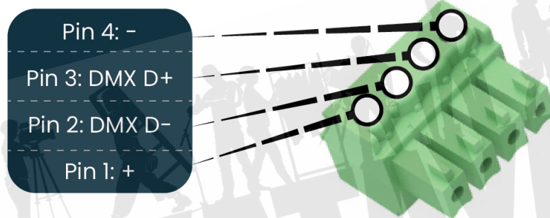
図 12：通常のDMX512ピクセルの出力ピン配置
