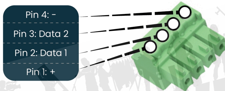
図 10：ピクセル出力ピン配置（拡張モード有効時）
