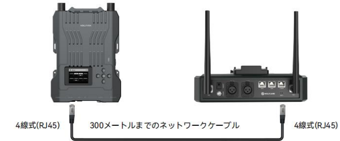
他のHollylandインターカムシステムとの接続 Solidcom C1 Pro—4線式インターフェイス経由
