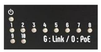
1段目: SwitchMaster の電源状態を表示します。SwitchMaster 動作中は**常に緑色に点滅** します。
