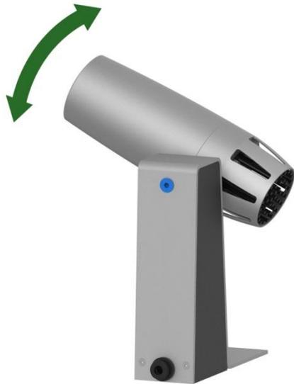
Lösen Sie die Senkkopfschraube M6x12mm mit einem Innensechskantschlüssel 4mm. Schwenken Sie den Projektionskopf in die richtige Position und ziehen dann die Senkkopfschraube wieder fest an.
